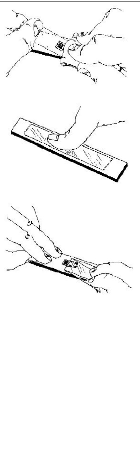
步驟十三：用同樣的器具將應變規之焊點上錫，先用紙膠帶將導線固定於試片上，於靠近應變規處，以棉花棒(CSP-1)之桿端或是
