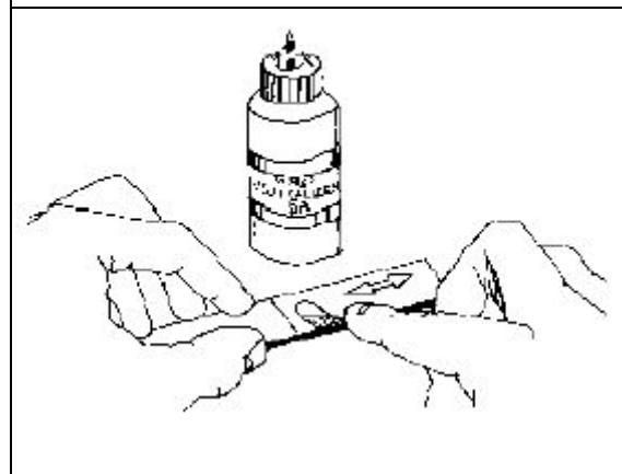
步驟三：用水性的中性劑(Neutralizer 5A)，以棉花棒將表面再清除一遍，再以紗布以單方向清潔擦拭一遍。
