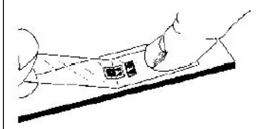
步驟七：將 M-BOND 200 KIT 打開，取出藍色玻璃瓶裝之催化劑，以毛刷沾取催化劑，並於瓶口沾抹十次，再以毛刷側邊輕刷於應變規背面。
