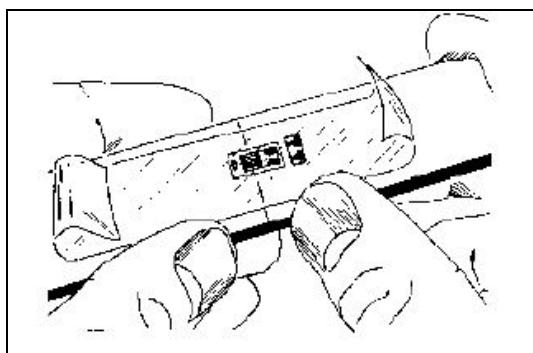
步驟六：一手按住膠帶之一端，另一手將膠帶的另一端以 45 度反向拉起，直到應變規整個離開試片表面，將膠帶後翻，使應變規欲黏貼面朝上。
