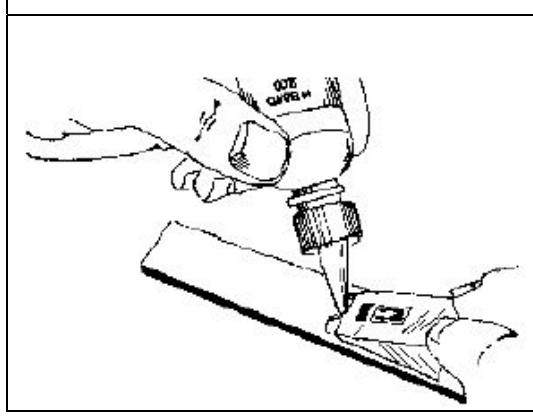
步驟十：以大拇指壓住應變規，利用大拇指施壓力並將溫度傳導給應變規，持續一分鐘。
